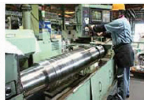
円筒研削盤（オークマ製） 650×3150L 2台
