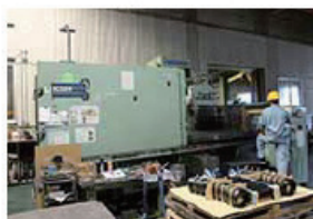
平面研削盤（住友重機製） 800×2000L 2台
